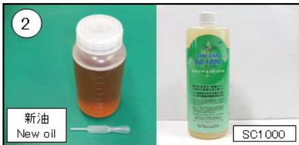
②洗浄液 1)未使用の潤滑油、又はダイハツ指定の洗浄剤 (汚れが大きい場合に使用) (別紙洗浄剤 SC1000 資料を参照のこと) Cleaning liquid 1) New lubricating oil or Cleaning liquid designated by Daihatsu Diesel. (In case of heavy contamination) (Refer to documents of cleaning liquid SC1000)
