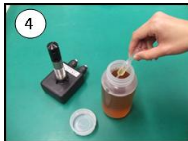
④新油又は洗浄剤をスポイトに吸い取る。 Sucking new lubricating oil or cleaning liquid with syringe.
